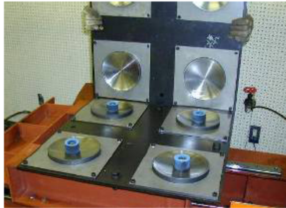
사진2 베어링과 면진패드를 설치한 시험장비
