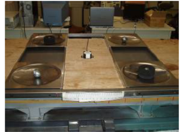
사진3 베어링과 면진패드를 2대를 연결 설치한 시험장비
